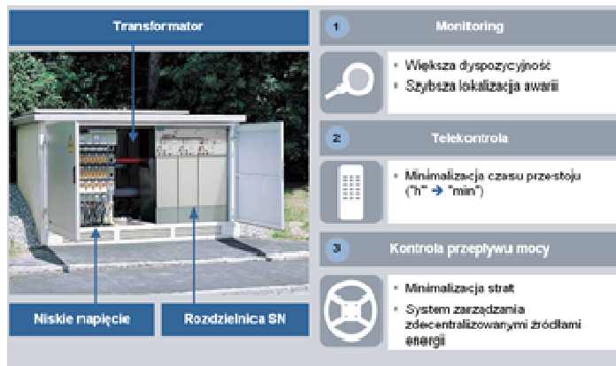
Fig. 4. Poziomy Inteligentnych Stacji Transformatorowych [4]
